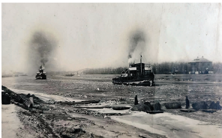
900 马力的“清凌”号破冰船在实施海河破冰作业,后面的货轮跟随航行。破冰船的船头右侧印有“CHIN-CLINC”(清凌)英文字样。
