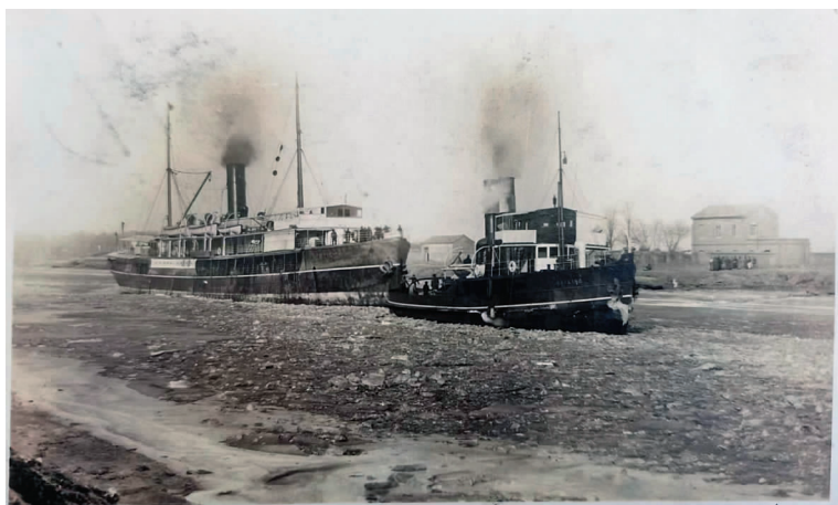
894 马力的“没凌”号破冰船在实施海河破冰作业,后面的货轮跟随航行。破冰船的船头右侧印有“MEILINC”(没凌)英文字样。
